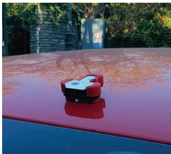
1-2. Dettaglio del MeteoTracker ed esempio della sua collocazione sul tettuccio di un'automobile. Gli appositi algoritmi di correzione del software permettono una misura ragionevolmente affidabile di temperatura e umidità relativa anche con lo strumento esposto alla radiazione solare, purché il veicolo sia in movimento con velocità da circa 10 km/h in su (f. G. Antoniciello).
