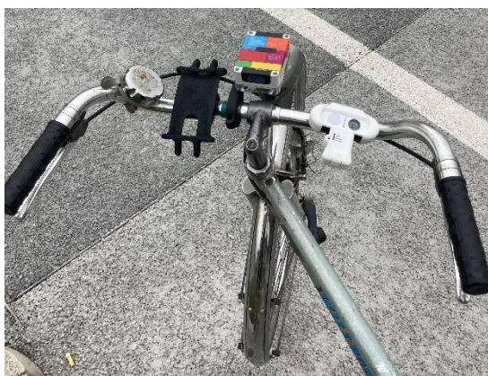
Figura 6 Esempio di installazione su bicicletta dei device MeteoTracker© e Open-Seneca.
